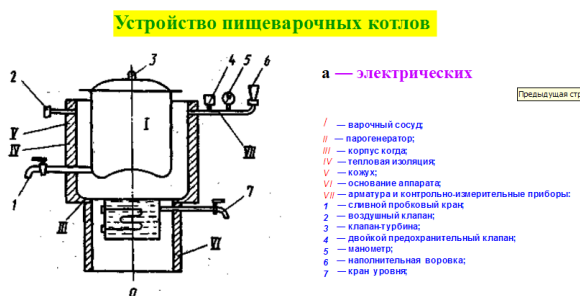
Рис. 1 Устройство пищеварочных котлов (наглядное изображение).
