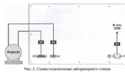
Рис. 2. Схема подключения лабораторного стенда
